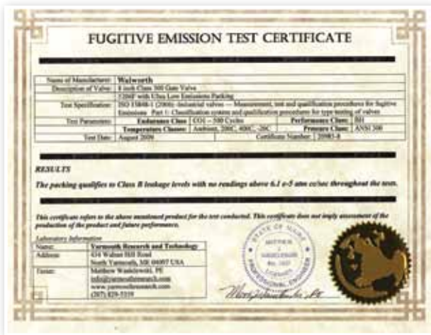
Certificado de Emisiones Fugitivas de 500 ciclos para válvulas de compuerta de 8" clase 300#, emitido por Yarmouth Research and Technology, que califican toda la gama de productos de Acero Fundido.
