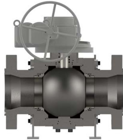
Cuando se requiere reducir la capacidad de fluido sin necesidad de utilizar reductores se utiliza el diseño de puerto reducido (*Reduced Port*); cuando se utiliza este tipo de válvula, se debe conocer qué tipo de diablo (*pig*) pasará por la tubería para evitar que se quede atorado a la entrada de la válvula, de lo contrario se atorarán causando un severo problema que requerirá el paro del proceso.
