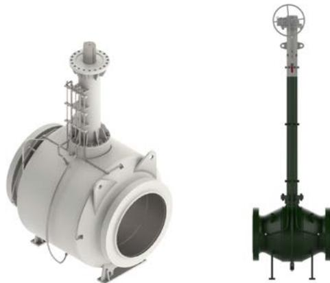
Walworth® cuenta con la tecnología para diseñar, fabricar y suministrar válvulas para servicio bajo tierra, con un diseño que incluye extensión de vástago, tubo de extensión al cuerpo (*pipe pups*) venas de lubricación que permiten lubricar los asientos y la cámara de empaques, así como abrir la válvula de venteo y/o válvulas de drenado desde la superficie.
