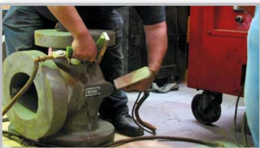
**Prueba de Partículas Magnéticas.-** WALWORTH® cuenta con el equipo para pruebas por partículas magnéticas aplicada a materiales ferrosos susceptibles a magnetismo. Esta prueba se realiza por muestreo o cuando el cliente solicita la Certificación de Partículas Magnéticas.
