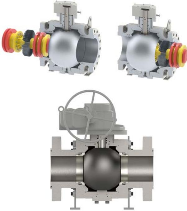
Debido a que el puerto no tiene interferencias en todo el trayecto de la válvula, el fluido pasa sin crear turbulencia; ésta función de paso completo y continuado (*Full port, through conduit*) también permite el paso de herramientas de inspección como diablos instrumentados o cepillos limpiadores (*pigs*) utilizados para propósitos de mantenimiento.
