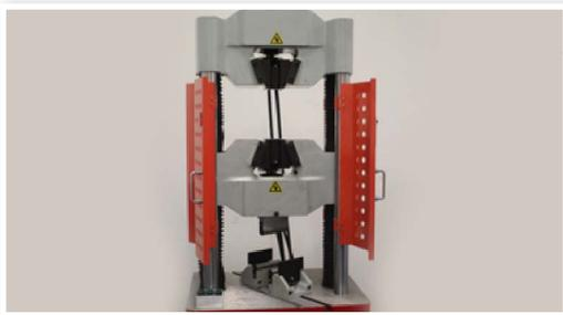
**Equipo de Prueba de Tensión.**- Para asegurar las propiedades mecánicas de los materiales empleados en la fabricación. WALWORTH® realiza pruebas por muestreo de probetas de las materias primas provenientes de nuestros proveedores, aún cuando se reciban certificaciones de calidad de las mismas.
